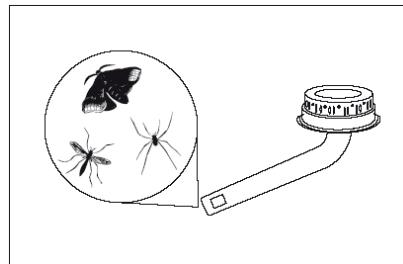
Ifall detta inträffar, stäng av gasventilerna till ”OFF” läge och vänta tills grillen är sval. När grillen har svalnat, lösgör brännaren och rengör blandarröret med en borste eller piprensare. Montera tillbaka brännaren enligt råd och försäkra att blandarröret är rätt över ventilen med munstyckena enligt råden. Var noggrann med att blandarröret är korrekt påträdda på ventilen.
