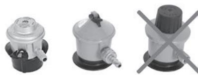
På bilden finns det 30 mbar lågtrycksregulatorer, som är rätt val till gasgrillen samt till höger en högtrycksregulator som får användas endast till gasverktyg. Använd inte den till gasgrillar.
